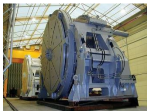
Кабельная машина барабанного типа на 40 тонн
