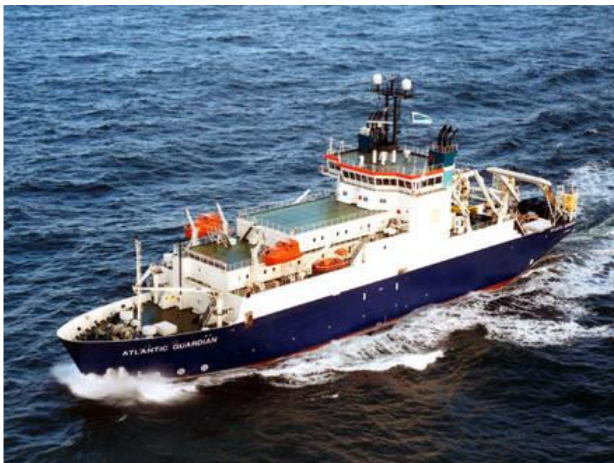
Рисунок 39 – Atlantic Guardian - судно для укладки и ремонта подводных кабелей
