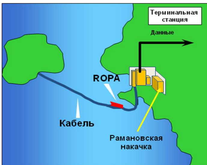
Рисунок 11 – Линия связи с применением РОРА и удалённой рамановской накачки
