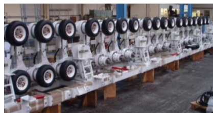
Линейная кабельная машина усилением 20 тонн
