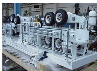
Система предварительного натяжения, 4-6т
